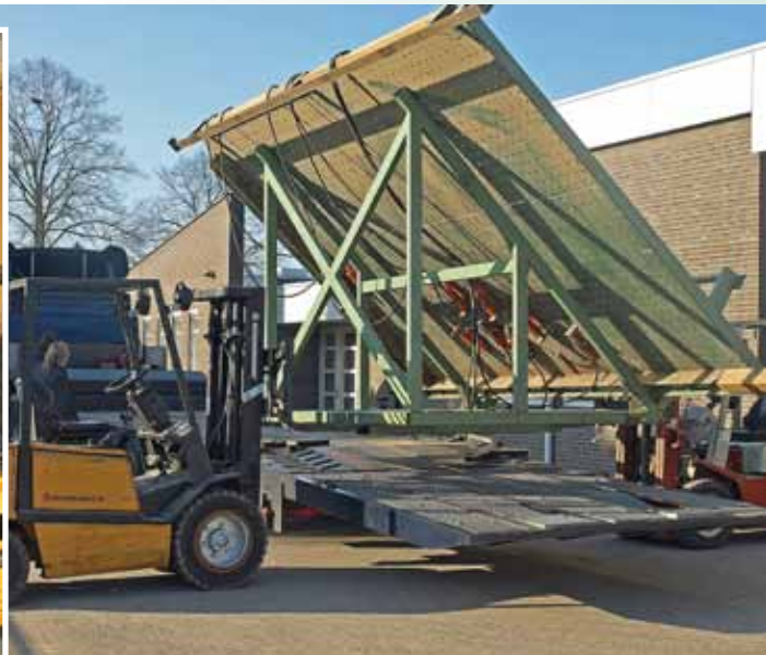
Een dieplader wordt onder de opsluitbank gereden, deze is met behulp van twee heftrucks uit de loods gehaald.
